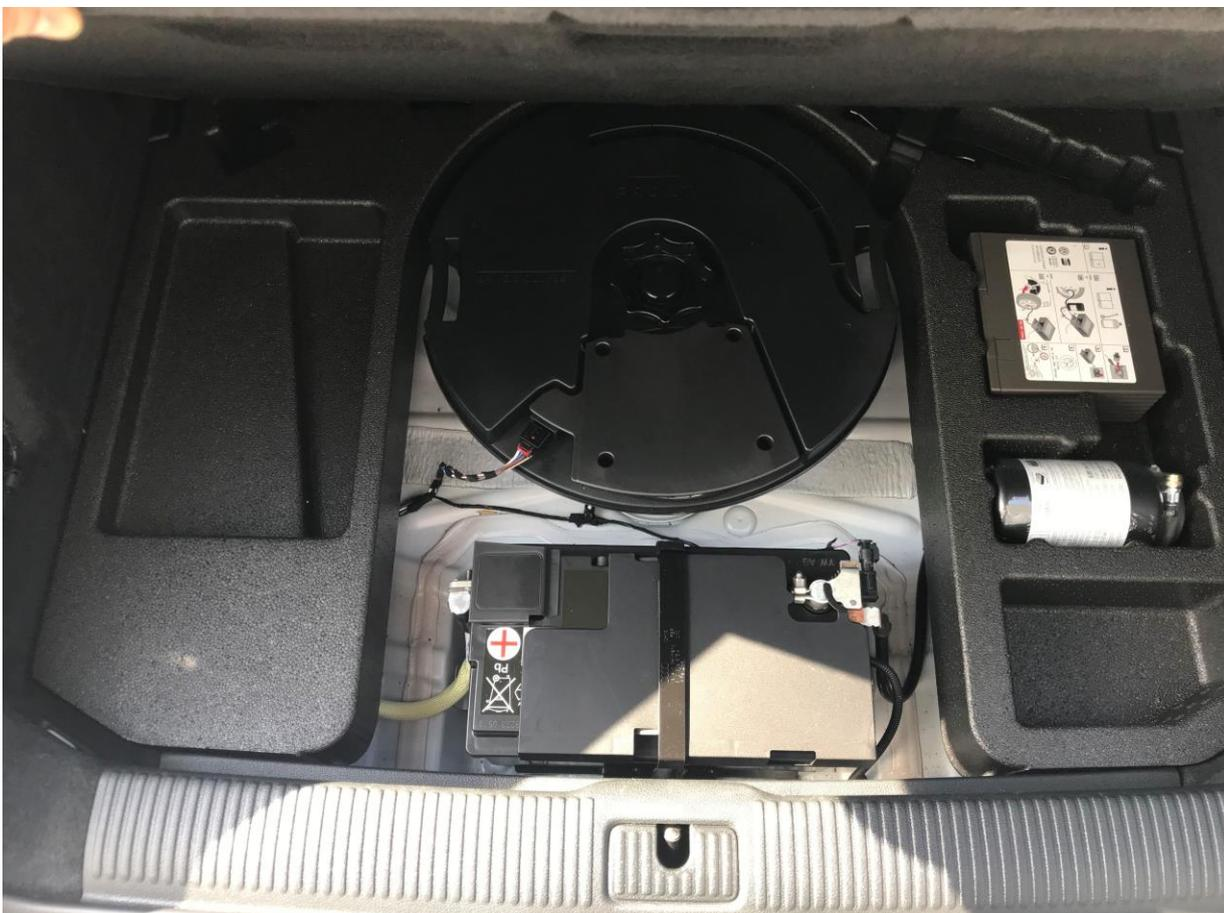
Entfernen Sie die Schaumstoffteile um die Kabel später besser führen zu können:
