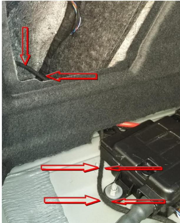
Links und rechts befinden sich jeweils 2 Möglichkeiten die Kabel der Steuerung nach unten zu führen, entweder die im Bild silbernen Abdeckungen oder die schwarzen Gummis. Passen Sie eines der beiden dem Kabel entsprechend an und führen Sie die Kabel links und rechts durch die Öffnung:
