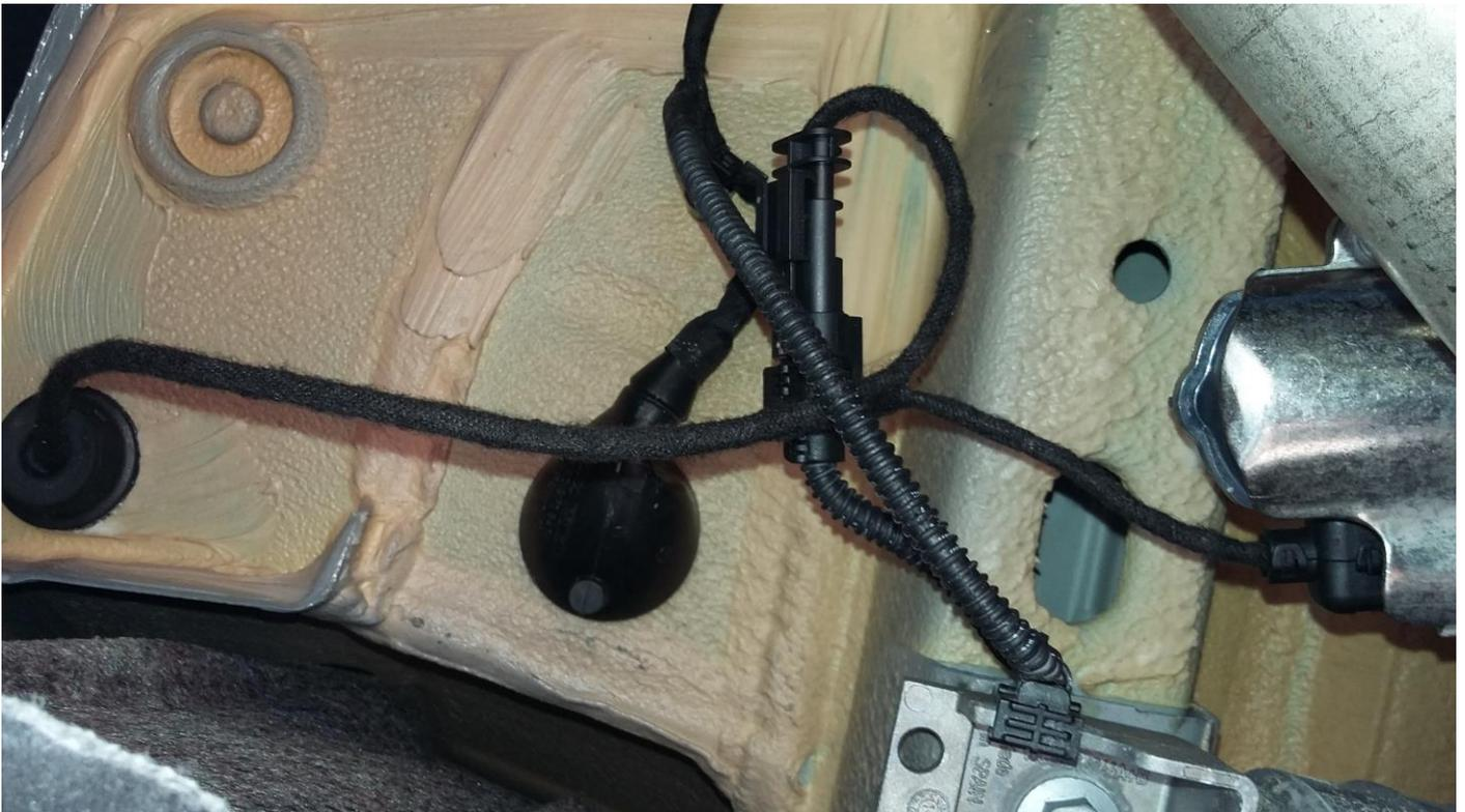
Bei Fahrzeugen mit einem Stellmotor links + rechts können jeweils beide Y-Kabel links oder rechts verbaut werden, dies hat keinerlei Einfluss auf die Funktion der Steuerung.
