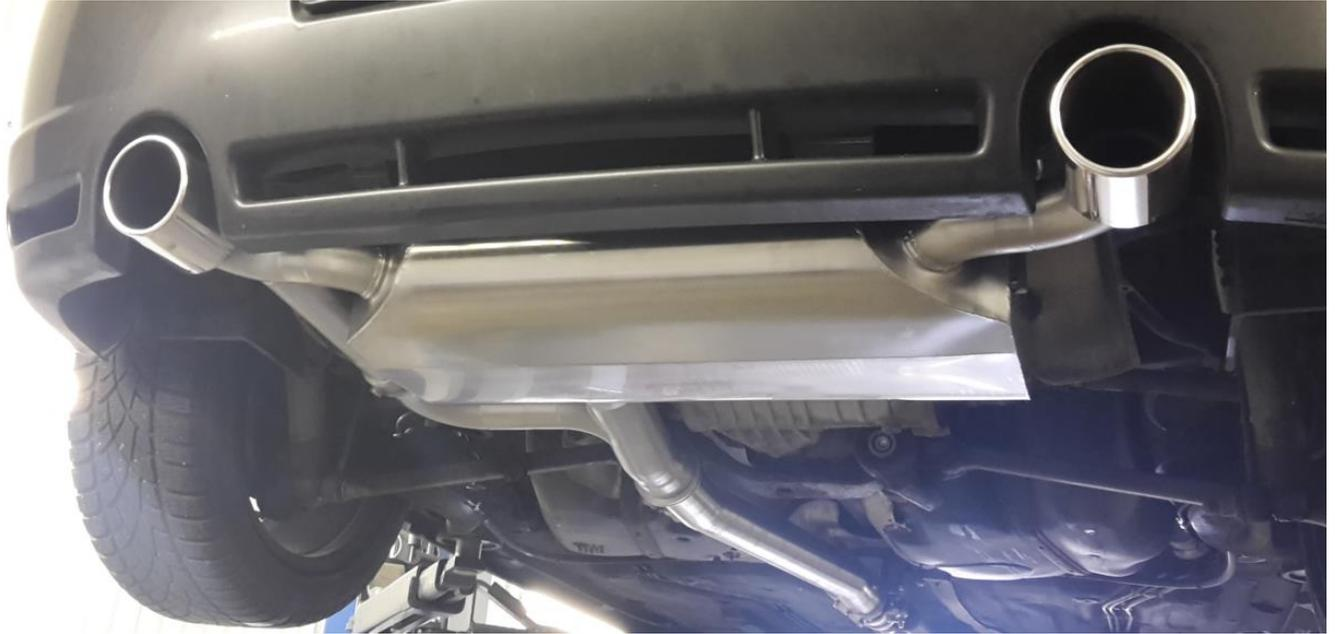
Auspuffanlage etwas herablassen und das Hitzeschutzblech ausbauen:
