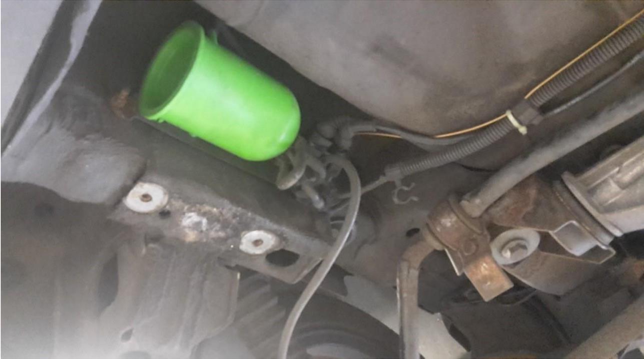
Den Serienstecker vom Magnetventil abziehen und auf den passenden Gegenstecker der Steuerung stecken. Den zweiten Stecker der Steuerung auf das Magnetventil stecken sowie das Massekabel mit der vorhandenen Mutter befestigen:
