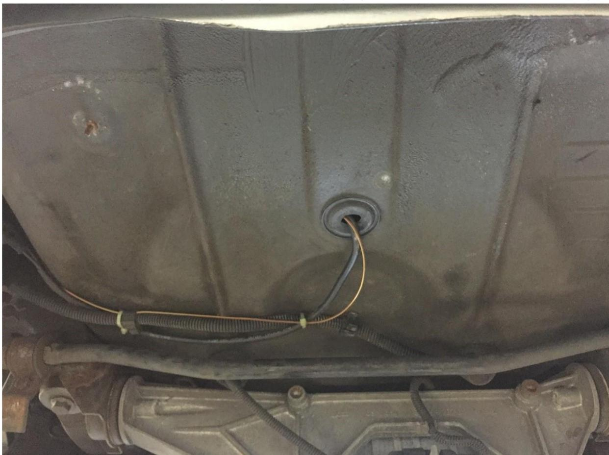
Die Kabel entlang der vorhandenen Leitung mit Kabelbindern befestigen und zur Unterdruckanlage führen:
