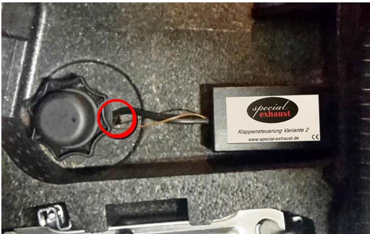
Anschließend die Kabel der Steuerung mittig durch den Styroporeinsatz sowie durch den Gummistopfen führen.
